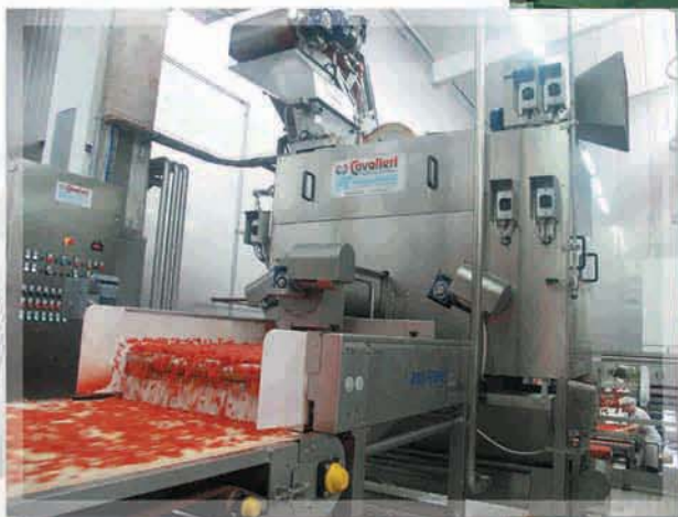
Pomodoro cubettato in uscita dalla macchina.
