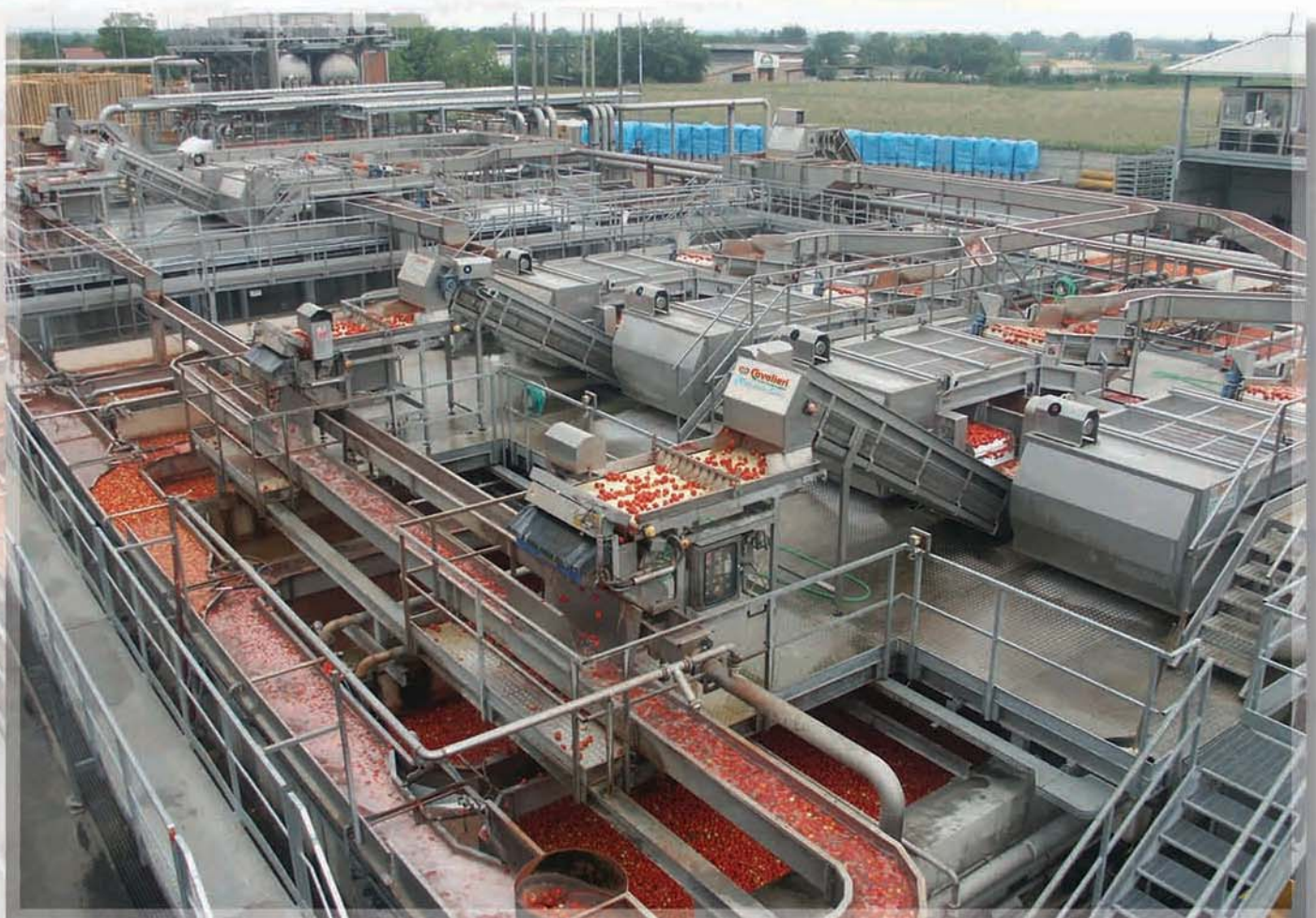
Insallazione di calibratrici in serie per alti quantitativi
